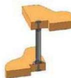
7. Еще одним элементом увеличения жесткости конструкции лестницы является использование болца. Под них необходимо будет просверлить отверстия 8мм.
